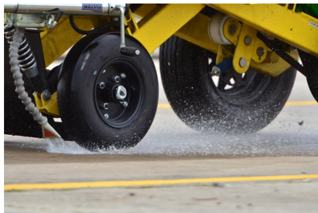
Figura 4. Dispositivo de medida para el ensayo Lock Wheel Tester.
